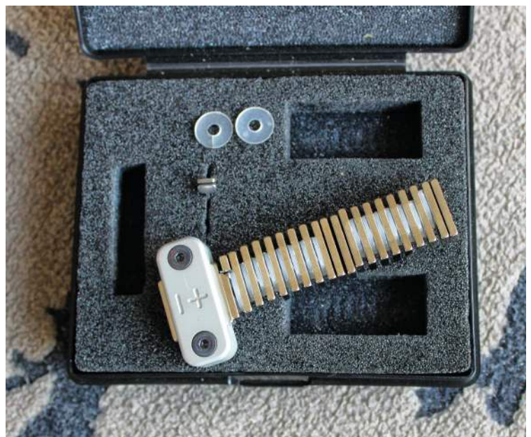
Bis zu 20 Gewichte können magnetisch am Laufbündel angebracht werden. Das Foto zeigt auch das dazu benötigte Werkzeug sowie die beiden Stopper, die verhindern, dass sich die Gewichte durch den Rückstoß nach vorne bewegen.
