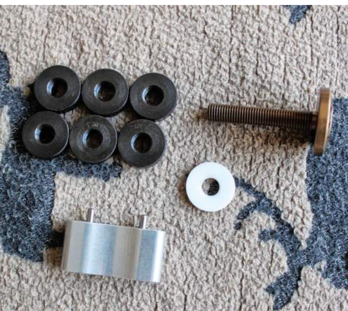
Bis zu 6 Gewichtsscheiben können mittels einer Schraube im Pistolengriff eingelassen werden. Das Bild zeigt außerdem das Werkzeug sowie eine Distanzscheibe aus Kunststoff (1 g).
